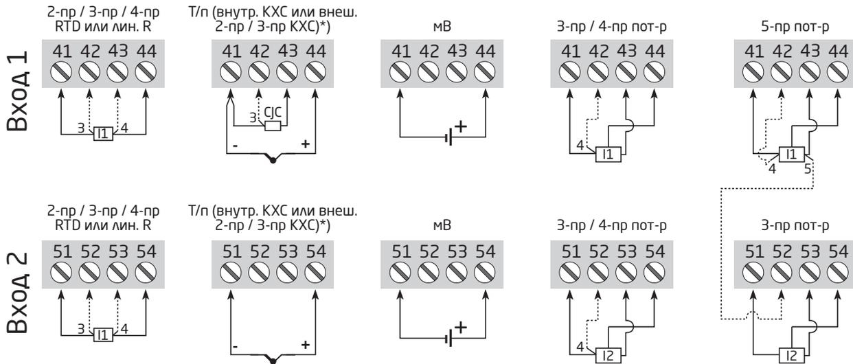
\* При использовании типа входа Термопара модуль 6437 можно настроить на постоянную, внутреннюю или внешнюю КХС с помощью чувствительного элемента Pt100 или Ni100. Этот выбор производится в процессе конфигурирования устройства.
